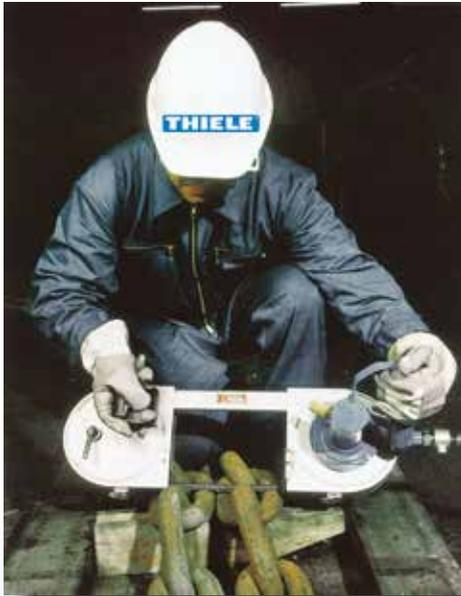
THIELE bietet pneumatische und hydraulische Sägen an, die unter Tage nicht nur zum Kettensägen genutzt werden können, sondern auch für andere Elemente, wie Rohre und Streckenausbau bis zu einem Durchmesser von 180 mm.
