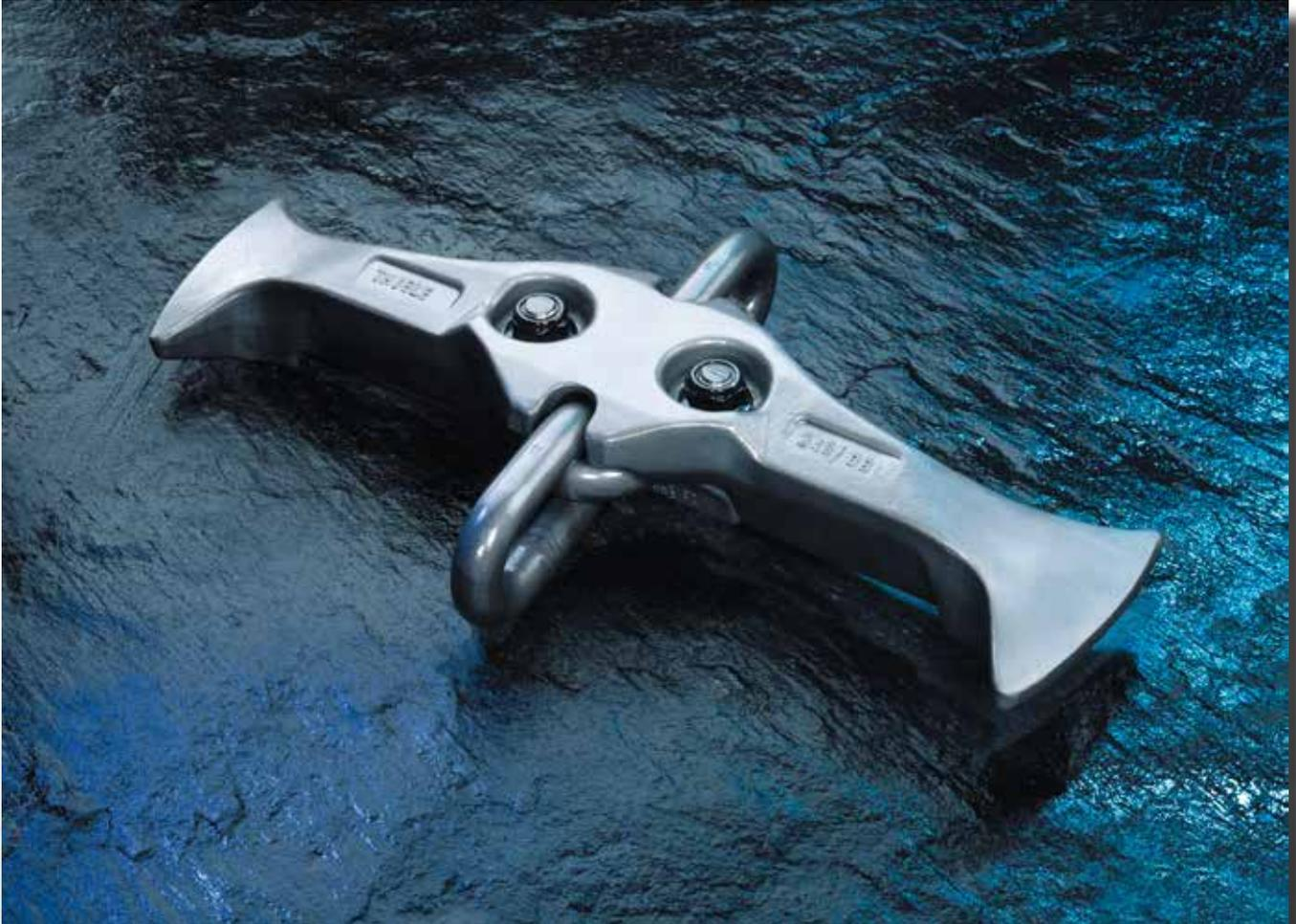
THIELE EKF Kratzer werden in Einzelkettenförderern eingesetzt. Das präzise geschmiedete und kalibrierte Kettenbett garantiert einen ruhigen Lauf des Kettenbandes und verhindert das Ausspuren der Kratzer aus dem Rinnenprofil.
