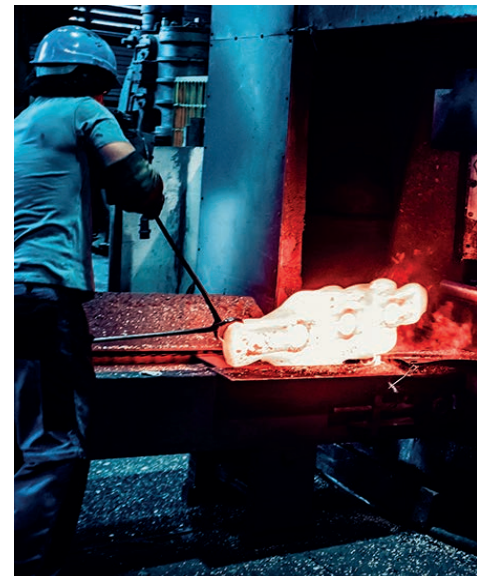
Als Ausgangsmaterial können quadratische Knüppel (Seitenlängen von 50 mm bis 120 mm) oder Rundmaterial (18,5 mm bis 200 mm Durchmesser) verwendet werden.
