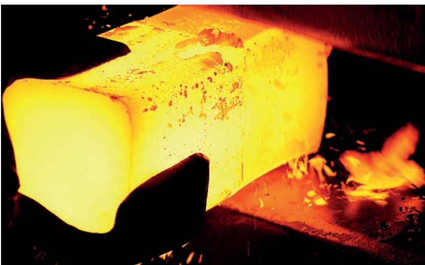
Als Ausgangsmaterial können quadratische Knüppel (Seitenlängen von 50 mm bis 120 mm) oder Rundmaterial (18,5 mm bis 200 mm Durchmesser) verwendet werden.
